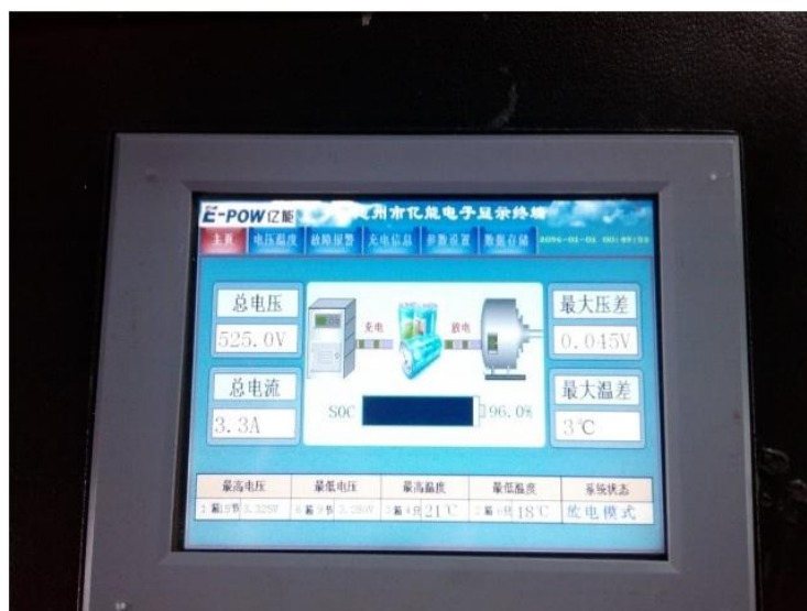
Slika 41: Nadzorna plošča v električnem avtobusu
