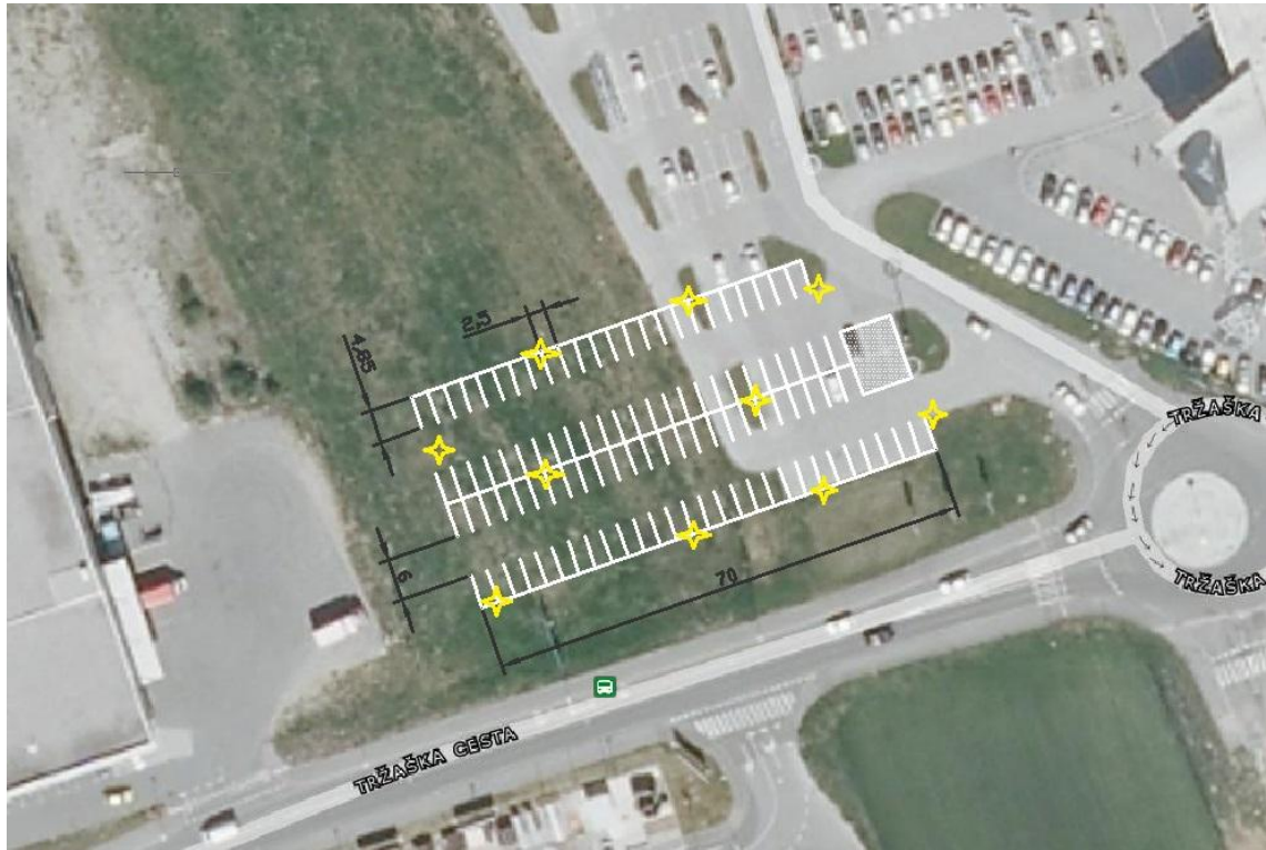
Slika 35: Model osvetlitve parkirišča z namenski led svetili
