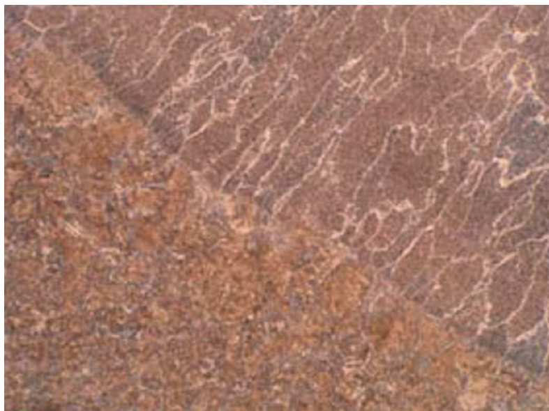
Slika 5.3: Mikroposnetek meje med varom in TVO [18]
