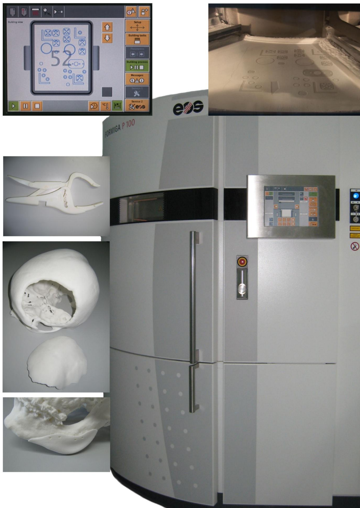
Slika 49: SLS naprava proizvajalca EOS Formiga P100. Prikazana je naprava, uporabniški vmesnik (zgoraj levo), izdelava enega sloja (zgoraj desno) in trije končani izdelki (levo). Naprava je od leta 2009 nameščena v prostorih Inštituta za proizvodno strojništvo FS Maribor.
