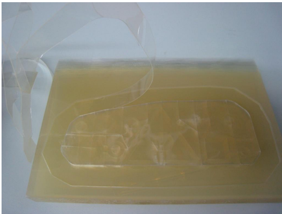
Slika 67: Odstranjevanje slojev, ki tvorijo ovojnico in podpore modelov, izdelanih po postopku LOM.
