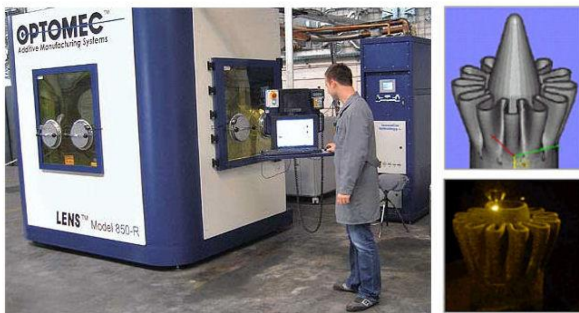
Slika 61: Naprava Lens Optomec 850-R. Dimenzije naprave so zaradi relativno velikega delovnega prostora in izdelave v zaščitni atmosferi relativno velike. Vir fotografij: www.optomec.com .
