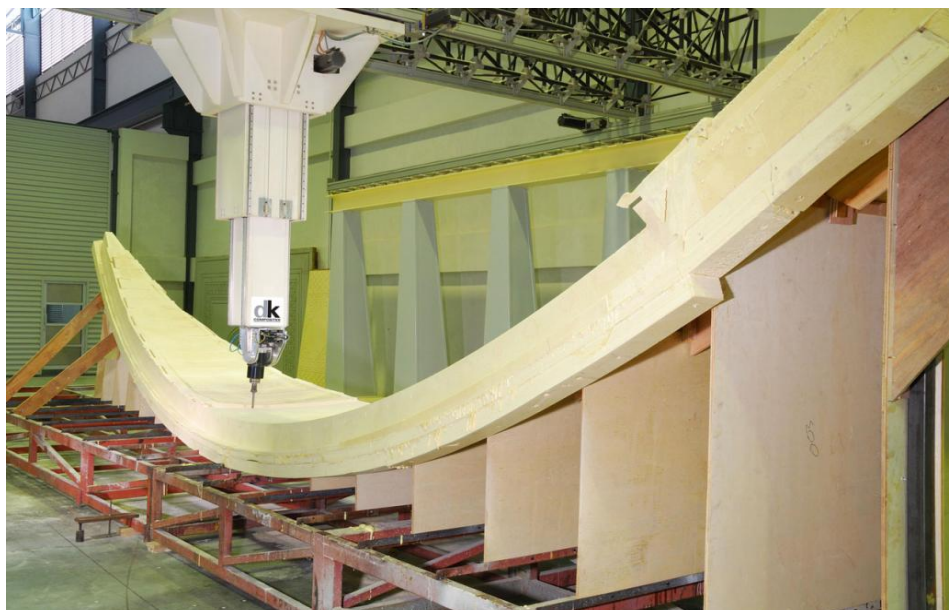
Slika 45: Velik CNC rezkalni stroj za izdelavo trupa jadrnice. Delovno področje stroja je velikosti 18 x 6,5 x 2,5 m. Vir fotografije: www.dkcomposites.com .
