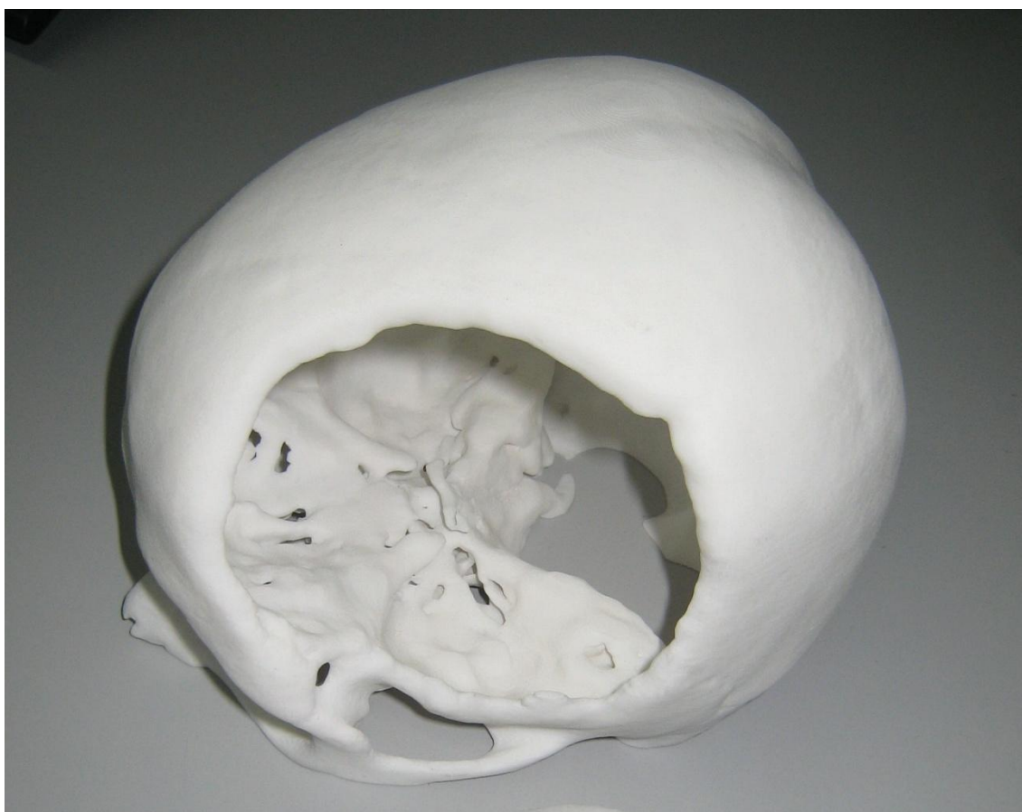
Slika 48: Primer izdelka, izdelanega s slojevitimi tehnologijami. Izdelava enakega izdelka s klasičnimi postopki je nemogoča (sploh v enem kosu) oziroma ni smotrna (cenovno in časovno).
