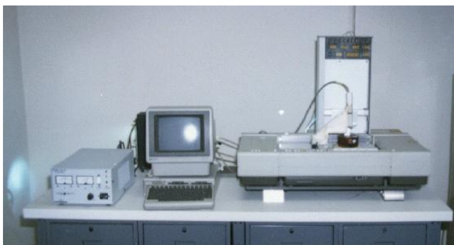
Slika 5: Prva delujoča naprava za izdelovanje izdelkov po postopku stereolitografije, najverjetneje izdelana v letu 1984. Vir fotografije: en.wikipedia.org/wiki/Stereolithography .
