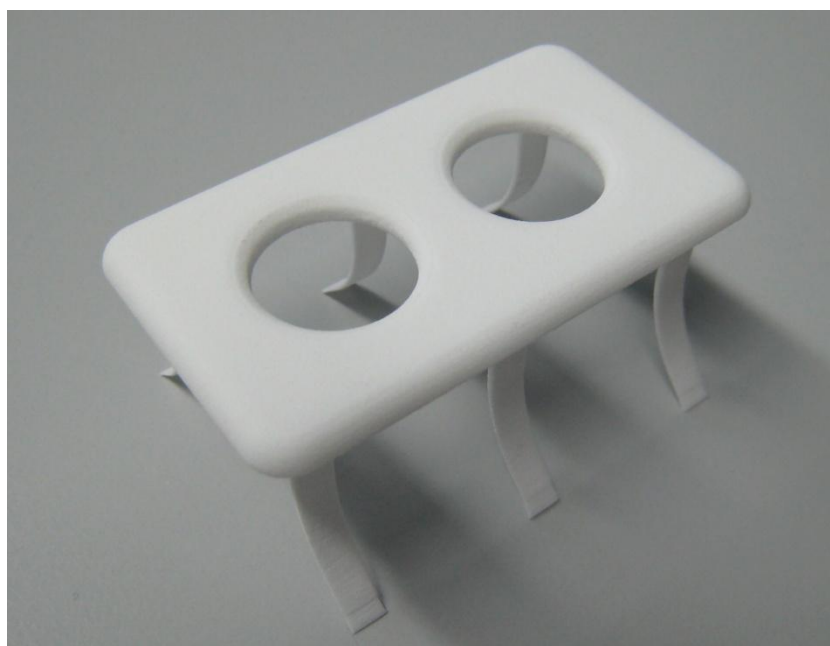
Slika 31: Model številka 9, izdelan iz Poliamida Pa 2200 na napravi za selektivno lasersko sintranje Formiga P100 proizvajalca EOS.
