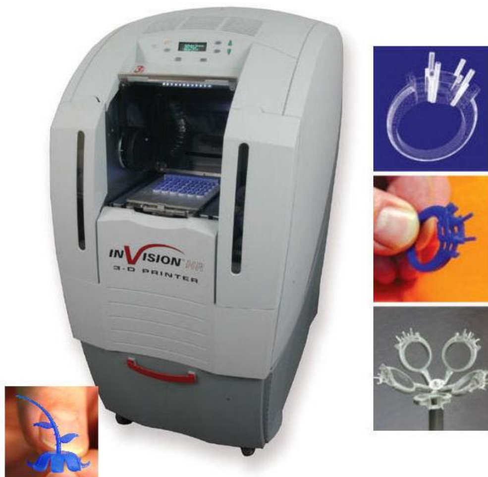
Slika 59: Naprava Invision HR proizvajalca 3D Systems omogoča izdelavo voščenih izdelkov visoke resolucije, primernih za zlatarsko industrijo, kjer se nato uporabijo kot pramodni v postopkih litja. Postopek je relativno počasn, izdelki krhki in kot taki neprimerni za končne izdelke. Vir fotografij: www.3dsystems.com .
