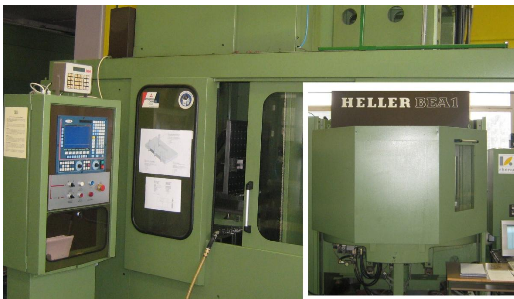
Slika 46: CNC rezkalni center Heller BEA1, nameščen na Fakulteti za strojništvo v Mariboru.
