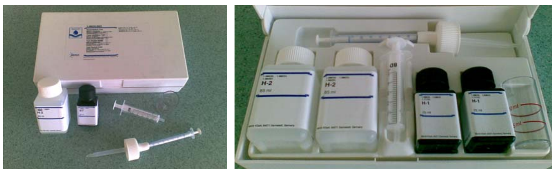
Slika 3.5: Hitri test Aquamerck ® 1.08039.0001, 1.08033.0001 za določevanje skupne trdote
