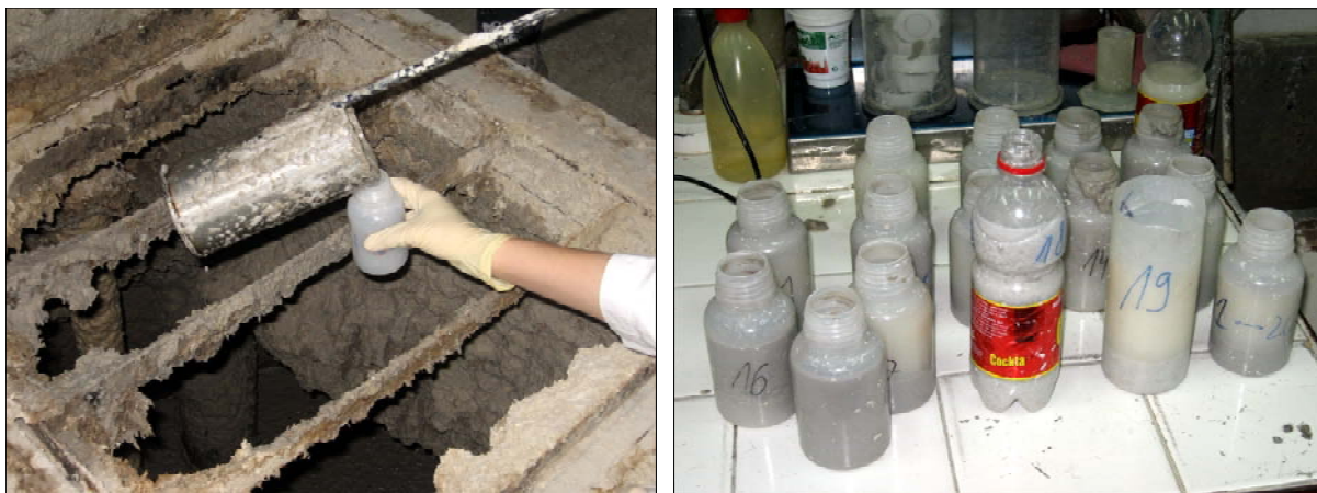
Slika 3.2: Vzorčenje pulpe na vzorčnem mestu št. 4 ter vzorci pulpe iz proizvodnje kartona
