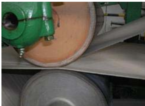
Slika 2.9: S stiskanjem se s papirnega stroja odstrani veliko vode
