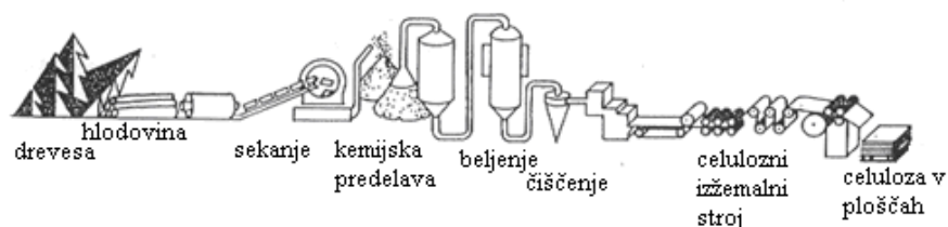
Slika 2.3: Pridobivanje celuloze iz lesa
