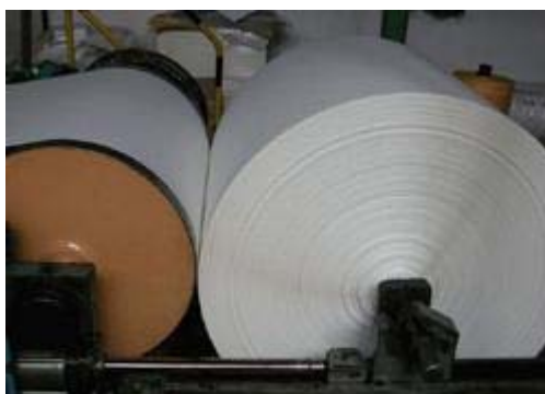
Slika 2.10: Navijanje papirja v bale
