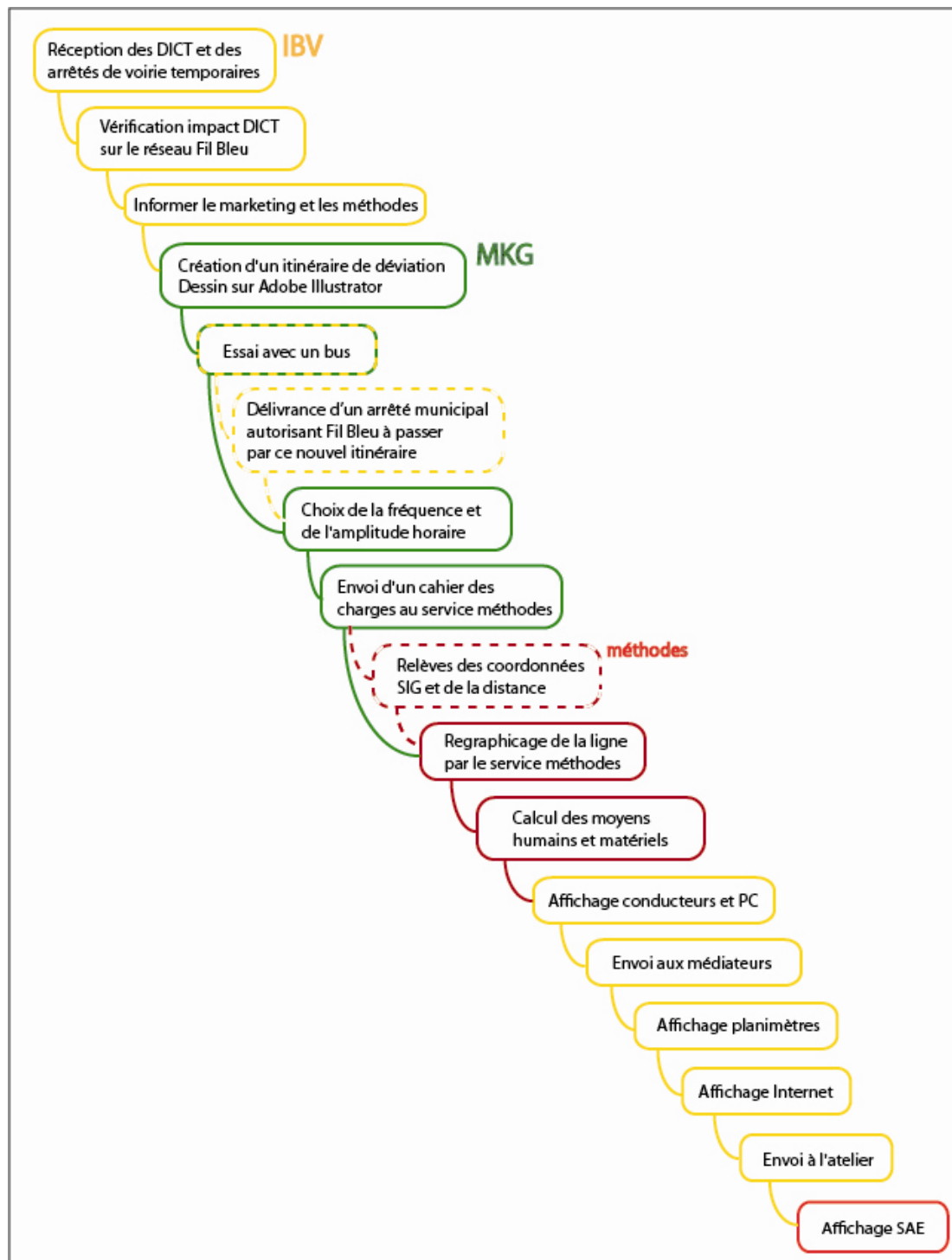
Image 21 : Création et diffusion d'une déviation en cas d'une grosse perturbation de d'une déviation longue durée (Source : Edith Grall, 2010)
