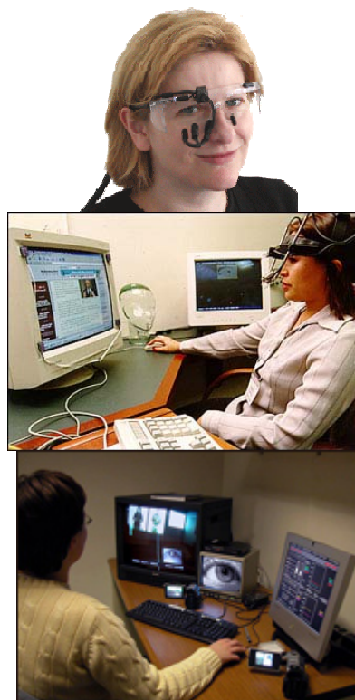
Fig. 1. Echipamente de urmărire a privirii
