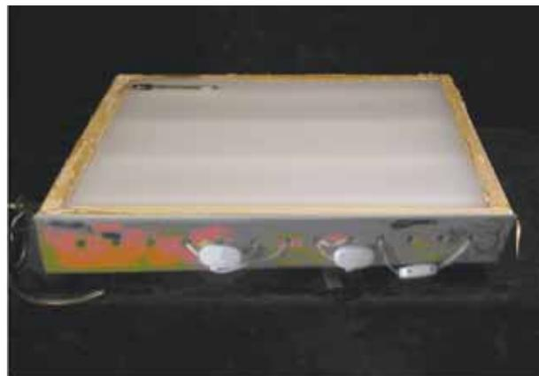
**Figura 7. Vista frontal de una mesa de luz de tipo (b).**
