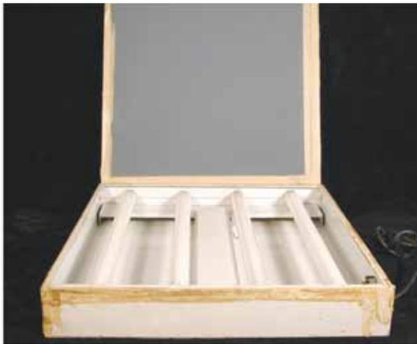
Figura 10. Mesa de luz de tipo (b) con la tapa abierta.
