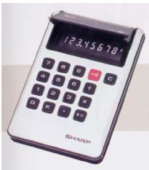
図 4 世界初の液晶ディスプレイを用いた電卓 EL-805 (シャープ、1973 年 4 月)
