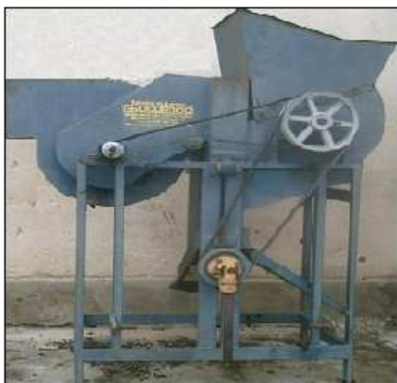
Figura 15 – Máquina de pré-limpeza da mamona
