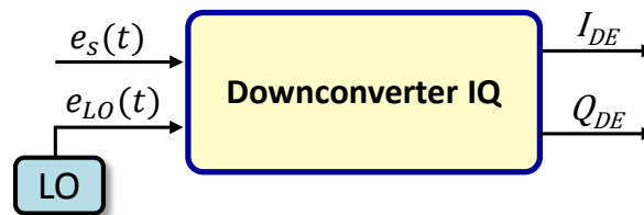
Fig. 4.4 Esquema elemental de un downconverter IQ.
