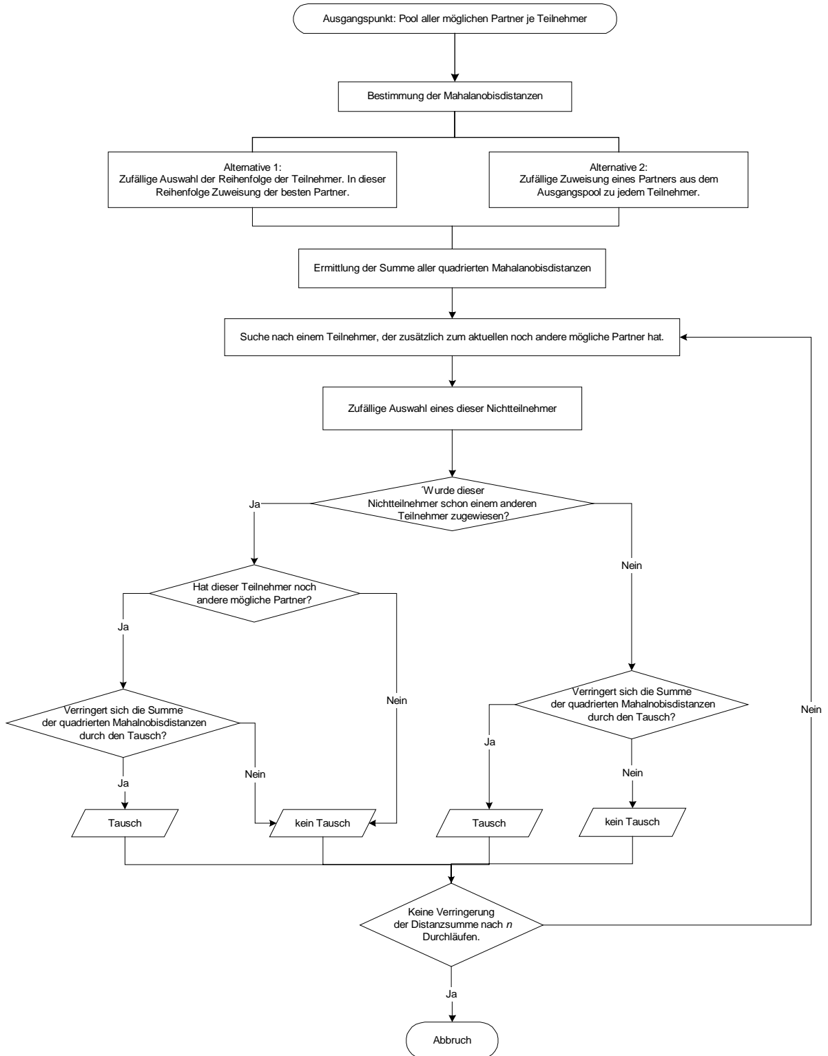
Abbildung 2: Ablaufschema des iterativen Verfahrens zur Zuordnung möglichst ähnlicher Nichtteilnehmer zu den untersuchten Teilnehmern
