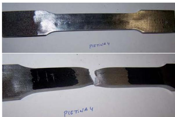
Figura 7.9: Probeta del perfil HEA200
