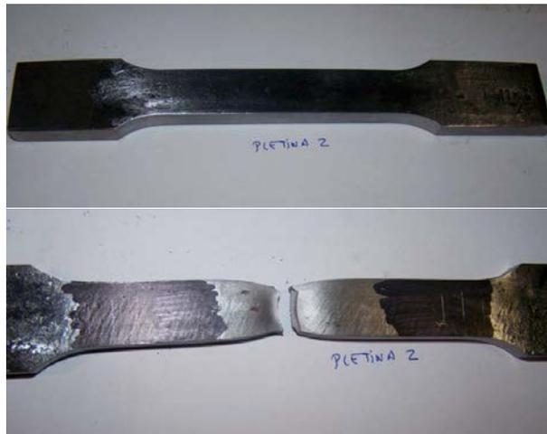
Figura 6.13: Probeta del perfil HEA280
