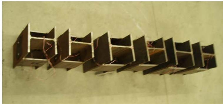
Figura 7.1: Especímenes E-stub
