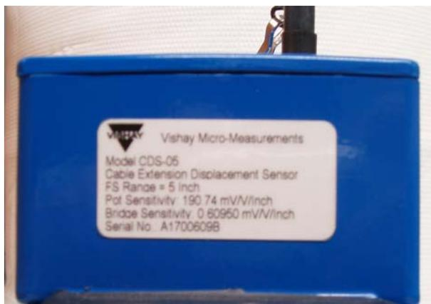
Figura 6.4: Sensores de desplazamiento
