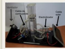
En este experimento (que se puede presenciar en la Muestra CAB IB) una celda solar provee energía eléctrica para producir hidrógeno y oxígeno a partir del agua contenida en los depósitos. Luego, esos gases se utilizan en una celda de combustible, que genera electricidad, la que finalmente impulsa un ventilador.
