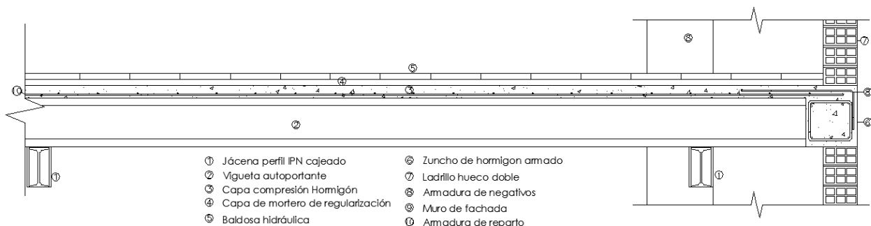
Imagen 2.5. Detalle 1 Forjado viguetas pretensadas y bovedillas
