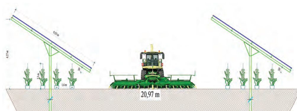
Slika 17. Ilustrativni prikaz funkcionisanja poljoprivredne mehanizacije na agrosolarnoj elektrani (izvor: Izveštaj o strateškoj proceni uticaja agrosolarnog projekta „Agrosolar Kula” na životnu sredinu, 2024)
