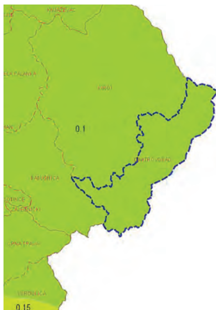
Slika 27. Karta seizmičkog hazarda za povratni period 475 godina, po parametru maksimalnog horizontalnog ubrzanja na tlu tipa A
