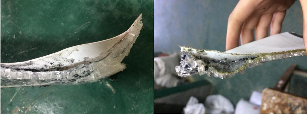
**Figura 8-9** Proceso de desmantelamiento de la cubierta posterior del módulo fotovoltaico.
