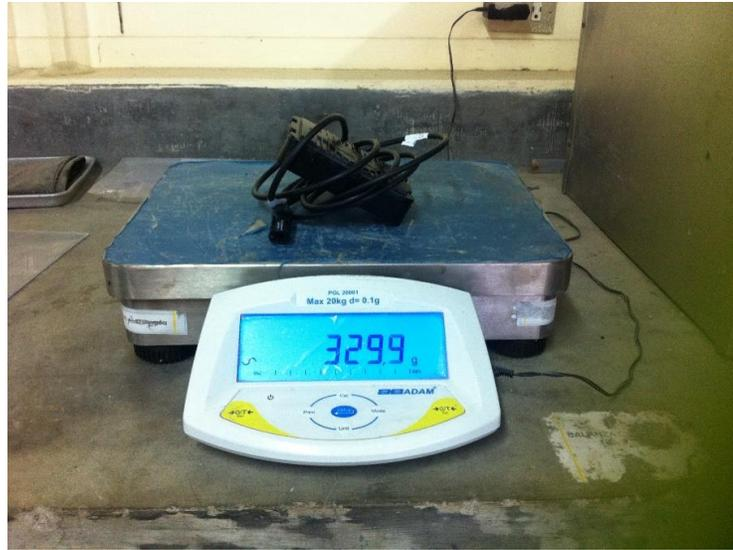
**Figura 8-3 Medición del peso de la caja de conexiones en balanza del CIVCO.**
