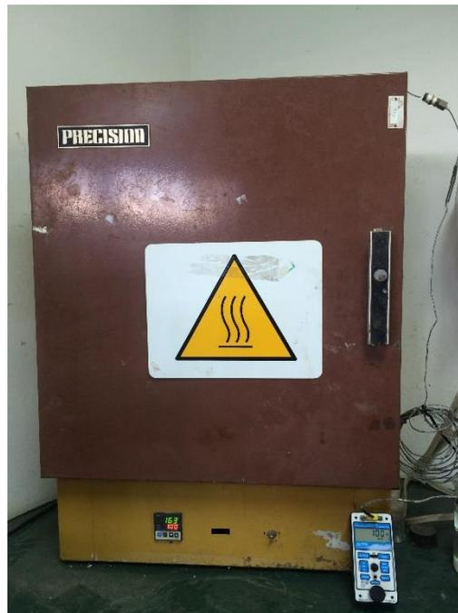
**Figura 8-6** Horno eléctrico utilizado para desmantelamiento del vidrio y la cubierta posterior del panel fotovoltaico.
