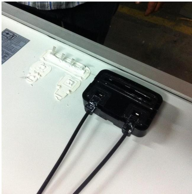
**Figura 8-2 Proceso de desmantelamiento de la caja de conexiones del módulo fotovoltaico.**
