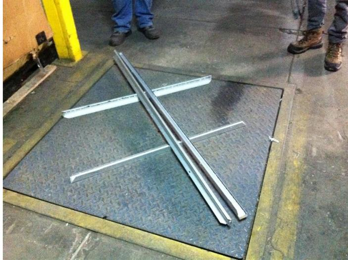
**Figura 8-5** Medición del peso del marco de aluminio en balanza del CTTM.
