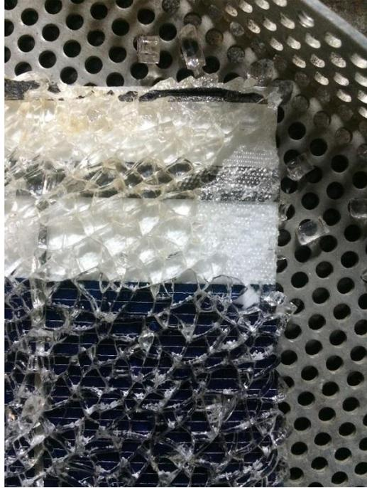
**Figura 8-7** Proceso de desmantelamiento del vidrio del módulo fotovoltaico.
