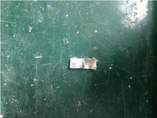
**Figura 8-10** Contacto metálico separado del módulo fotovoltaico.
