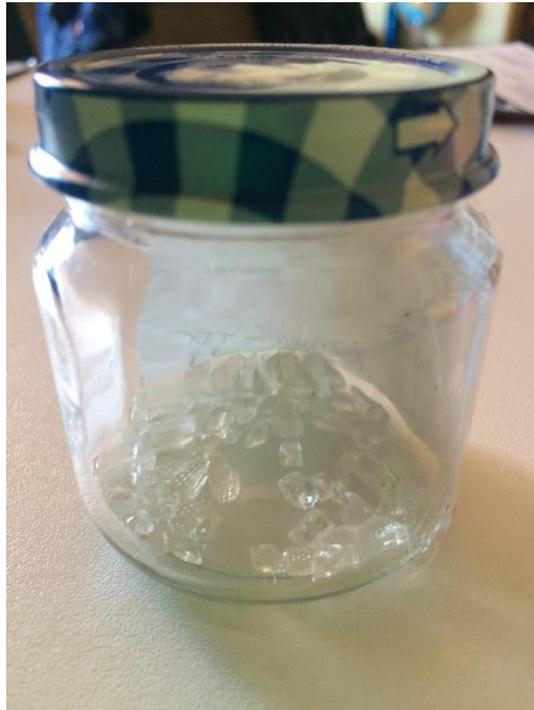
**Figura 8-8** Vidrio separado del módulo fotovoltaico.
