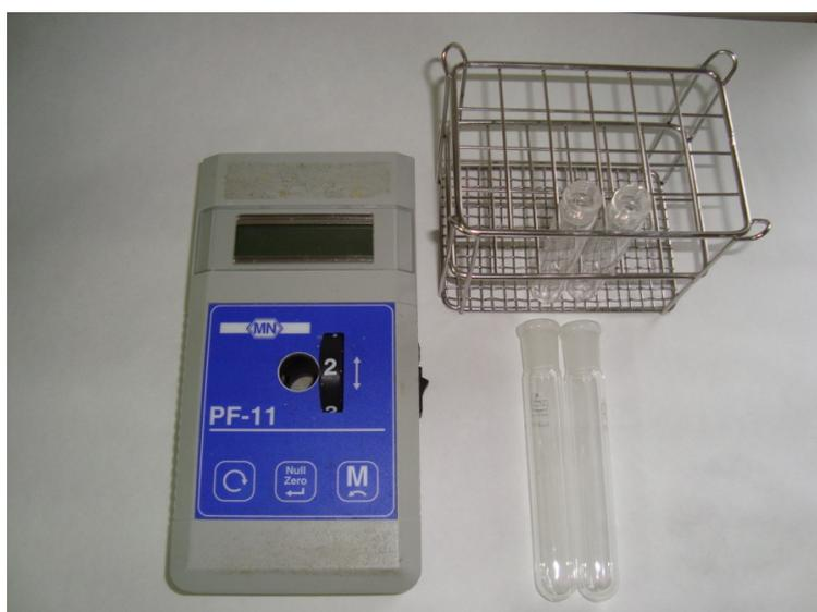
Fotografía 4.3. Fotómetro para análisis de sulfatos
