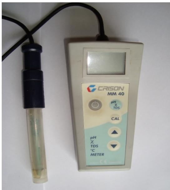
Fotografía 4.1. Equipo multiparamétrico Crison MM40
