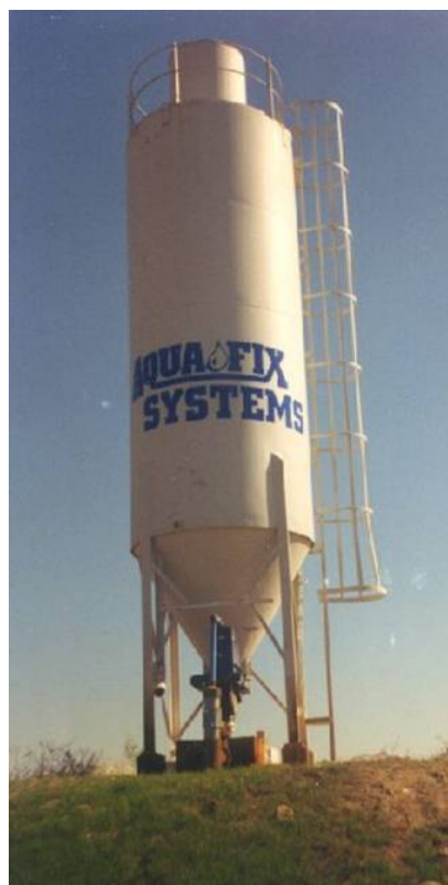
Figura 7.2: Tolva para la dosificación de alcalinos en el tratamiento activo del drenaje ácido de mina.
