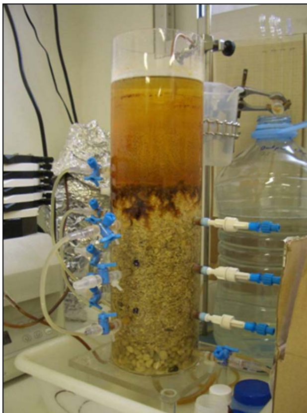
Figura 7.10: Columna rellena de material reactivo para el diseño del tratamiento de drenajes ácidos de mina. El flujo se efectúa de arriba abajo, se observan los precipitados que se producen en el contacto del material reactivo con el agua ácida.
