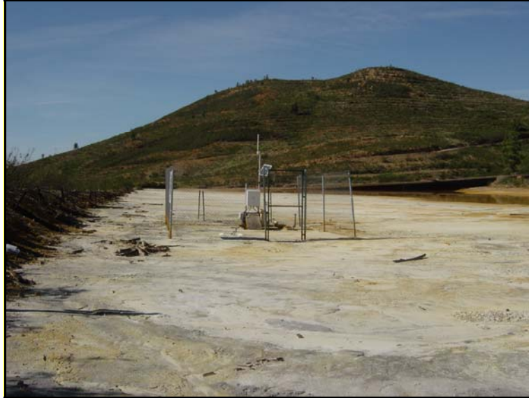
Figura 3.7: Balsa de lodos de las minas de Cueva de la Mora, donde se ha instalado una estación experimental para la investigación de los procesos de oxidación de sulfuros.
