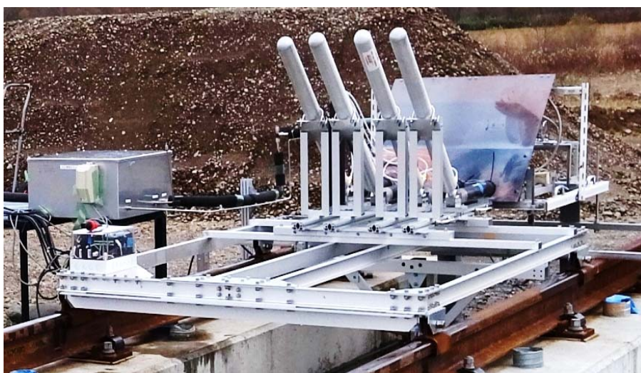
図1 RS702 型走行スレッド. アルミ合金製で全重量は 72 kg(データロガー, 推進装置除く).
