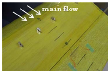
図6 流れの可視化(VG 0^\circ )
