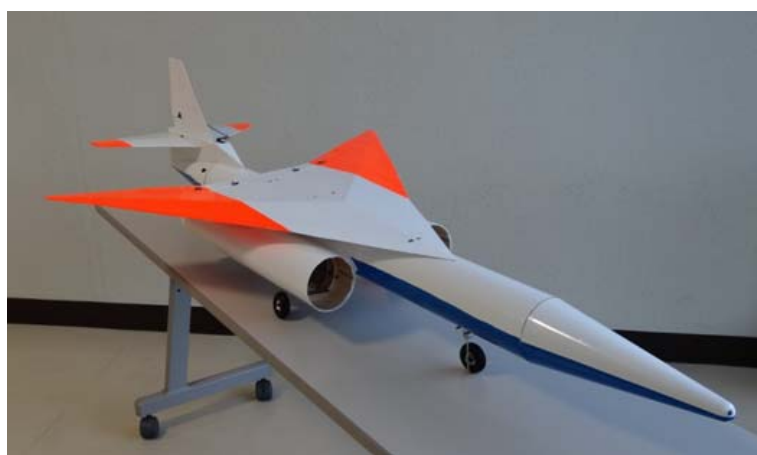
図4. 組み立てられた1/2スケール機体
