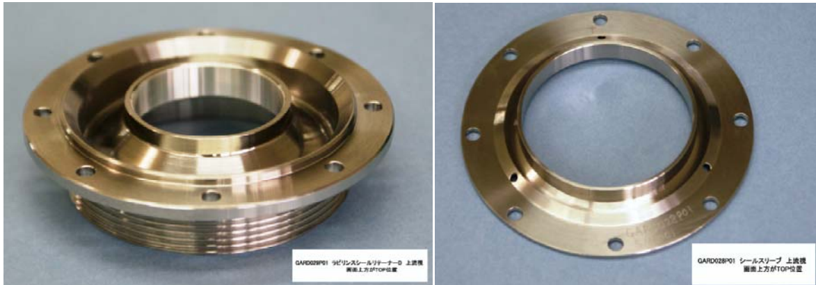
図3 H24年度に製作したエンジン部品 (左:ラビリンスシールリテーナーD 右:シールスリーブ)
