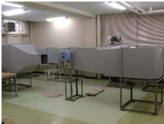
図1:低速風洞の概観
