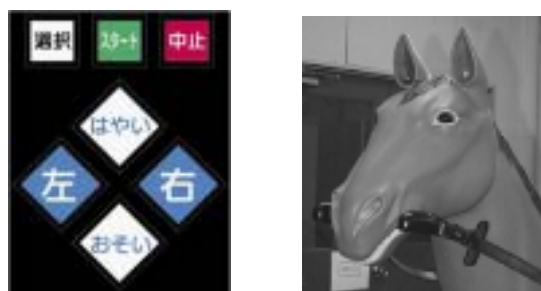
図14 VR乗馬療法システムのスイッチ部分
