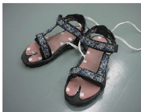
図 3.2 圧力センサを内蔵した履物
