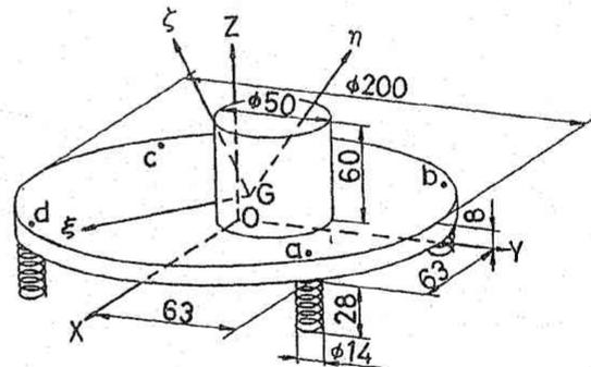
図5 鋼製供試体 (実験モデル)
