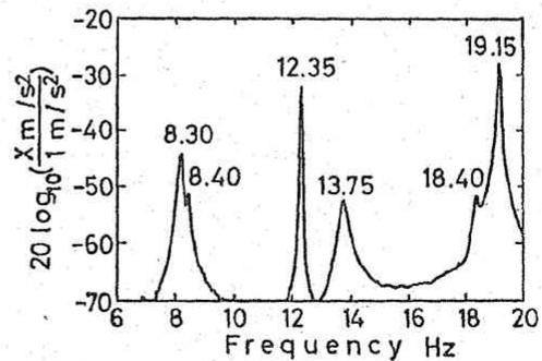
図6 パワースペクトル (点aのX方向の応答)
