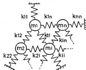
図1 多質点集中質量系モデル
