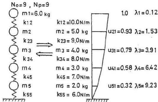
図7 五自由度系モデルのシステム同定例
