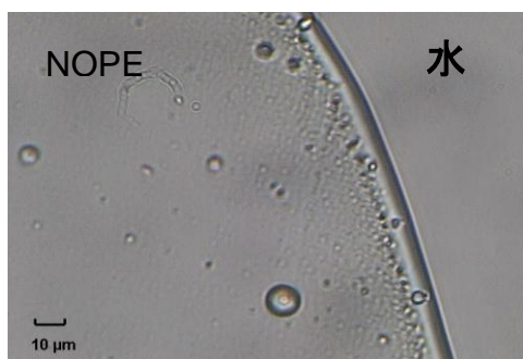
図 1. ガラス基板上に作成した油水界面の光学顕微鏡写真。
