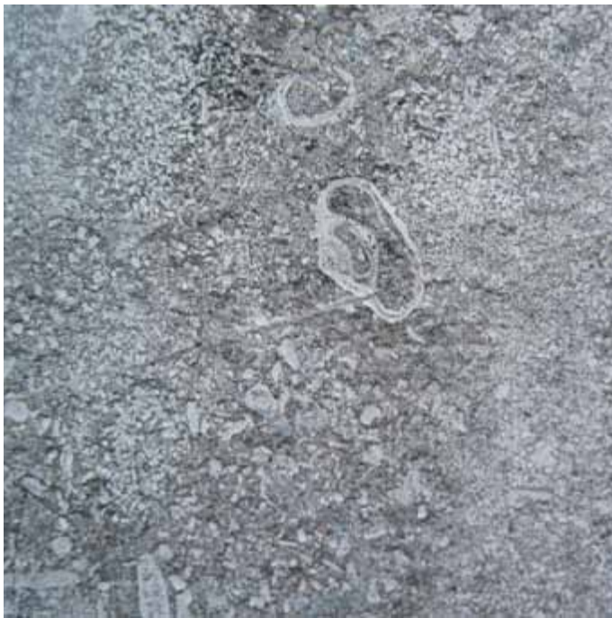
[5.15] Detailopname van het verweerde en bleekgrijs gepatineerde oppervlak van een Maaskalksteen. Minuscule kalkbolletjes (oölieten), afgeplatte algaire kalkknolletjes ('oncolieten') en macroscopische fossielfragmenten (slakjes). Raamomlijsting van een conventhuis (Roland Dreesen, 2006).
