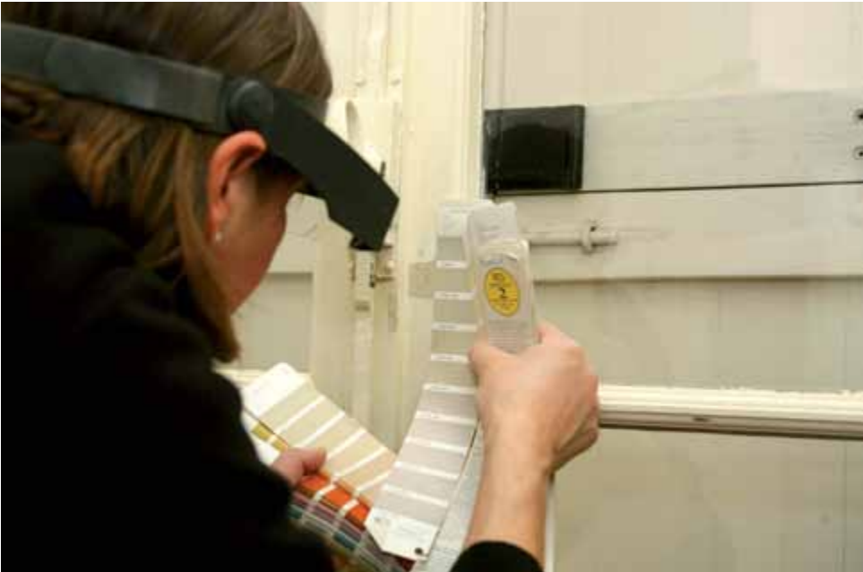
FIG. 15.2 De kleuren in de proefvensters worden gemeten en voorzien van een kleurenreferentie van het Natural Colour System (NCS).
