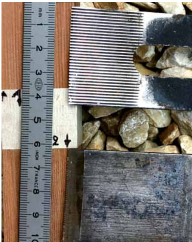
FIG. 16.11 Tandschaafmessen. Boven: met brede groeven (zestiende–achttiende eeuw). Onder: met smalle groeven (negentiende eeuw).
