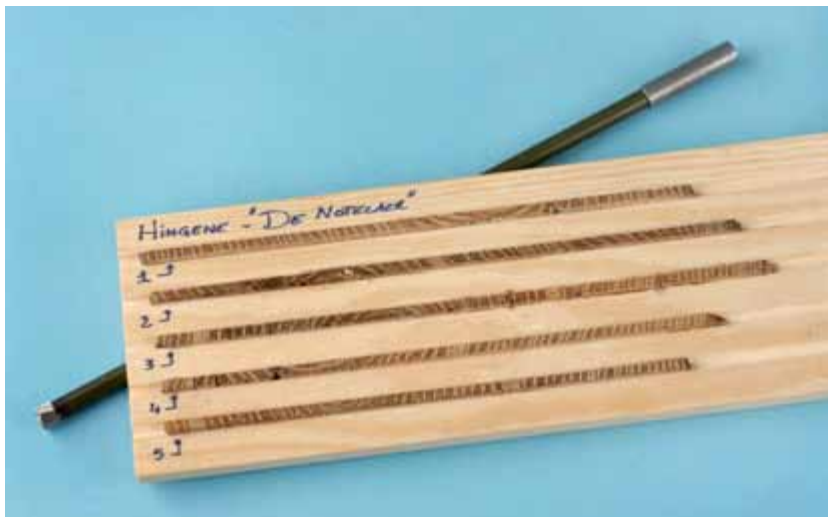
FIG. 14.2 Drooghoutboor en boorkernen uit de koepel.
