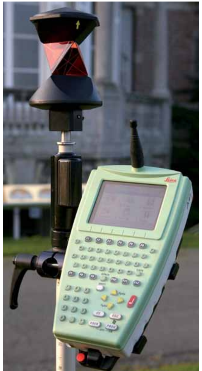
FIG. 13.6 Reflector (360°) en controller.
