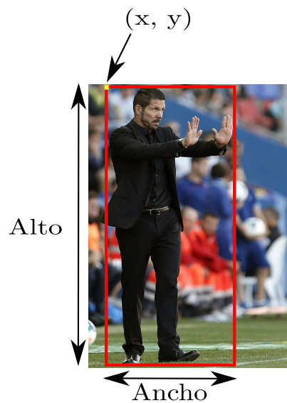
Figura 3.5: Especificaciones del “bounding box”.
