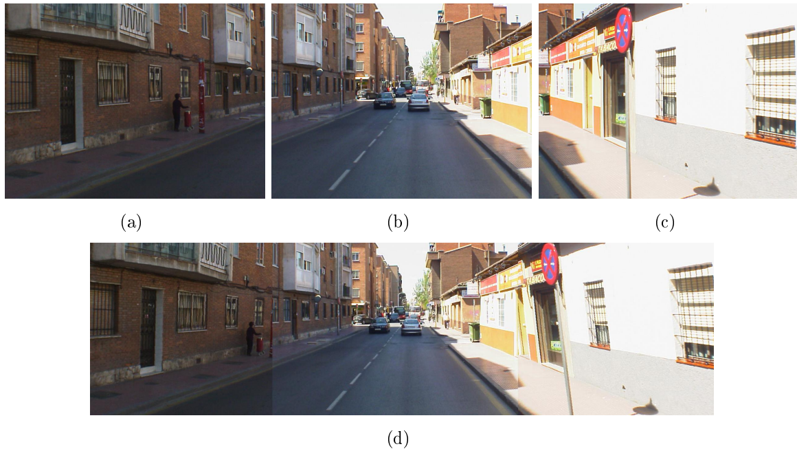
Figura 4.3: Construcción de una escena panorámica a partir de las imágenes captadas por las cámaras. (a) Imagen izquierda. (b) Imagen central. (c) Imagen derecha. (d) Imagen resultante del proceso de construcción.
