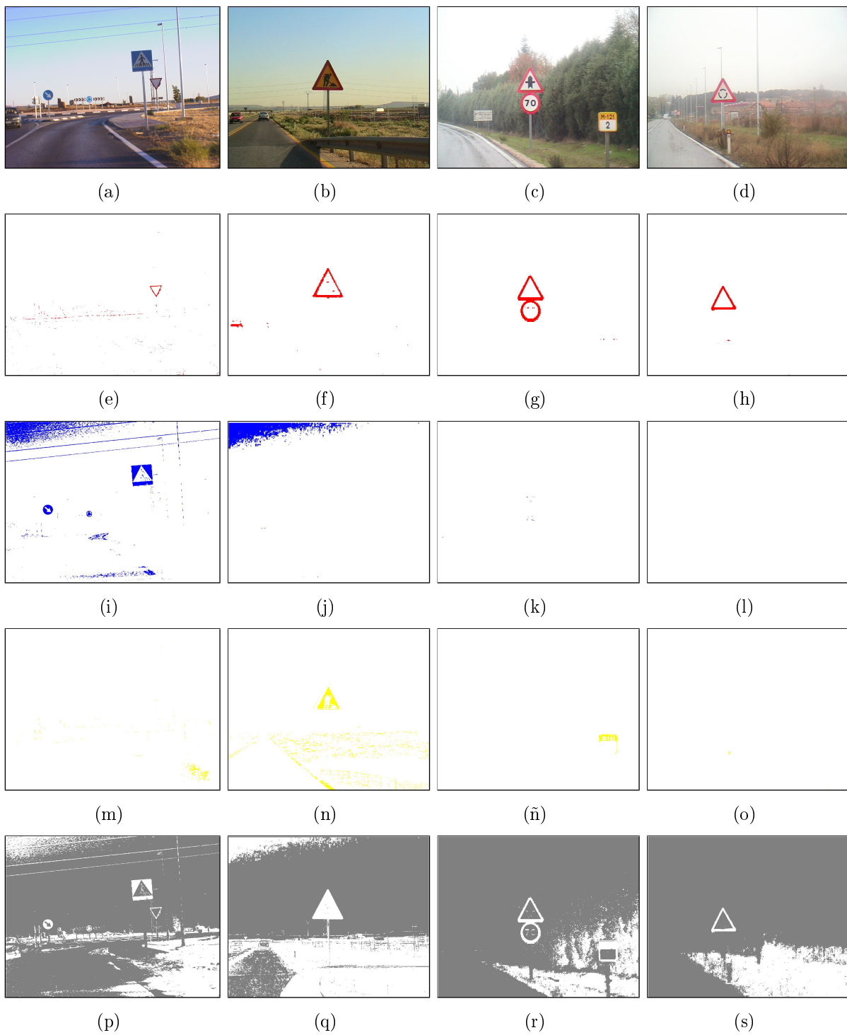
Figura 4.7: Ejemplos de segmentación. De arriba hacia abajo, imágenes originales, máscaras de segmentación del canal rojo, máscaras de segmentación del canal azul, máscaras de segmentación del canal amarillo y máscaras de segmentación del canal acromático.
