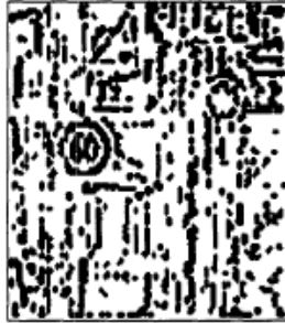
Figura 2.11: Imagen binaria obtenida en [Aoyagi96] tras aplicar un filtro laplaciano a la imagen para la obtención de bordes.
