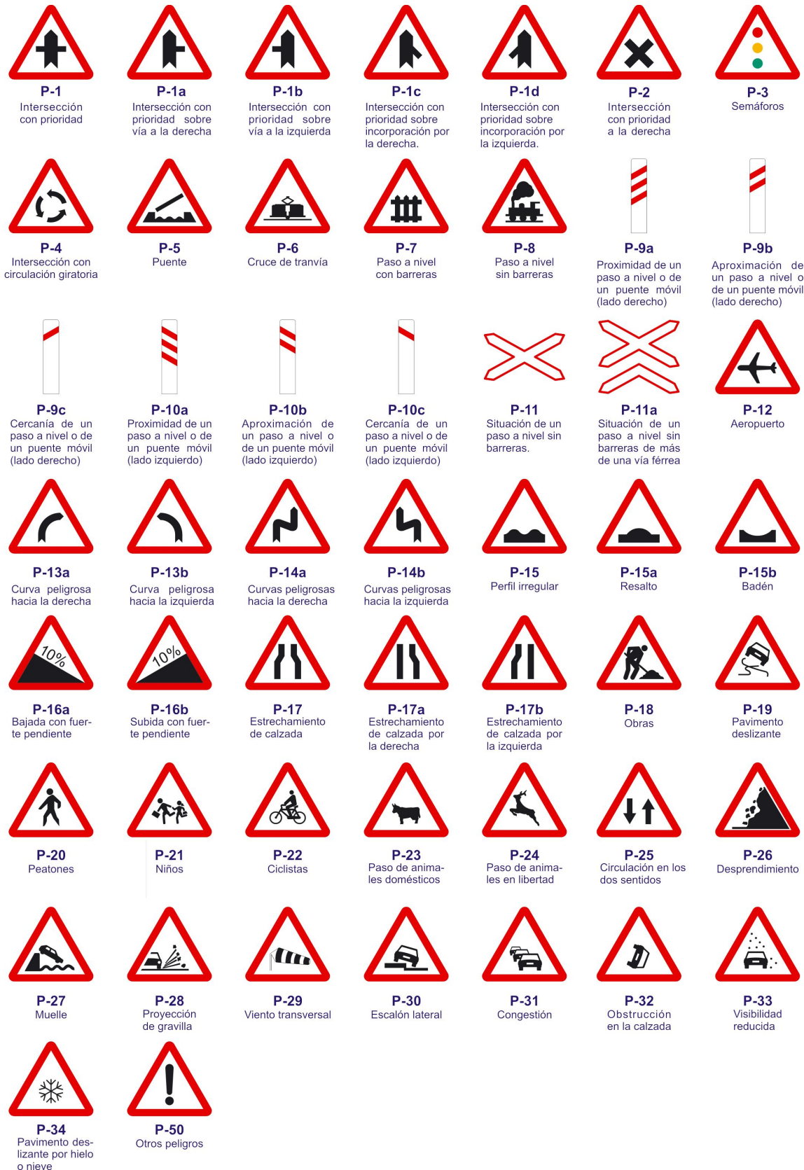
Figura C.1: Señales de advertencia de peligro
