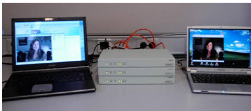
Figura 40. Foto de una de las pruebas en marcha de la implementación de ARP-Path en Linux/Soekris
