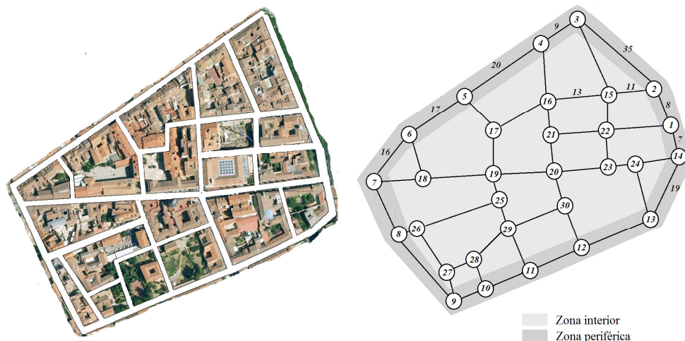
Figura 3.2. Vista parcial del Casco Histórico de Alcalá de Henares. (izda) Mapa métrico. (dcha) Mapa topológico correspondiente al mapa métrico, con las zonas interior y exterior definidas. Los números que aparecen en algunos de los arcos representan el tiempo requerido (en segundos) por un vehículo para atravesar las calles representadas por estos arcos, a una velocidad de recorrido de 24 Km/h.
