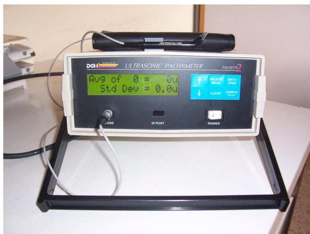
Fig 17: Paquímetro ultrasónico utilizado en el estudio.
