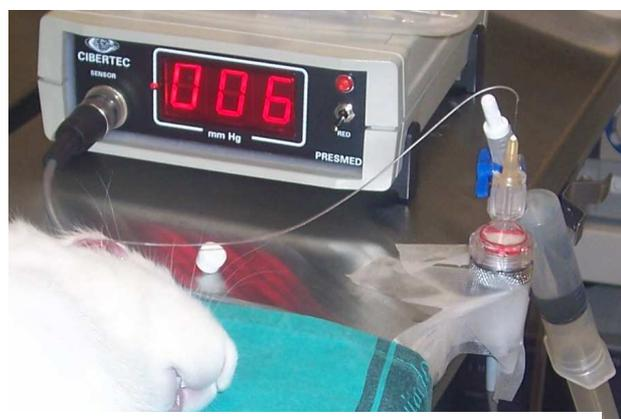
Fig 24: Imagen en la que se observa como una aguja de insulina se unia al barotransductor y a la cánula de silicona en los primeros intentos de medida que se realizaron. .
