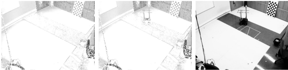
(a) Imagen del fondo invariante a la iluminación (b) Imagen de entrada invariante a la iluminación (c) Imagen de entrada en escala de grises
