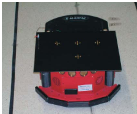
Figura 2.13. Array de diodos de infrarrojo empleados para el posicionamiento y guiado de un robot móvil en [Fernandez et al. 2007].
