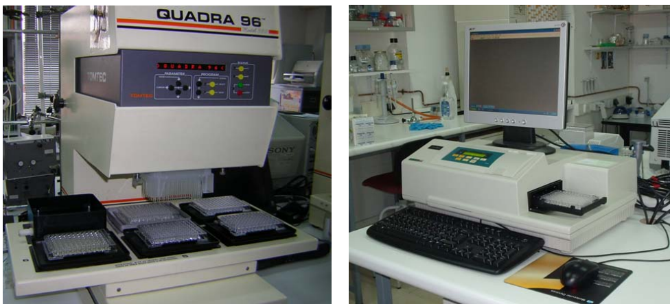
Figura 1.11. Robot manipulador de líquidos de 96 cabezales y lector de microplacas empleados en los experimentos de high throughput screening realizados en esta tesis.
