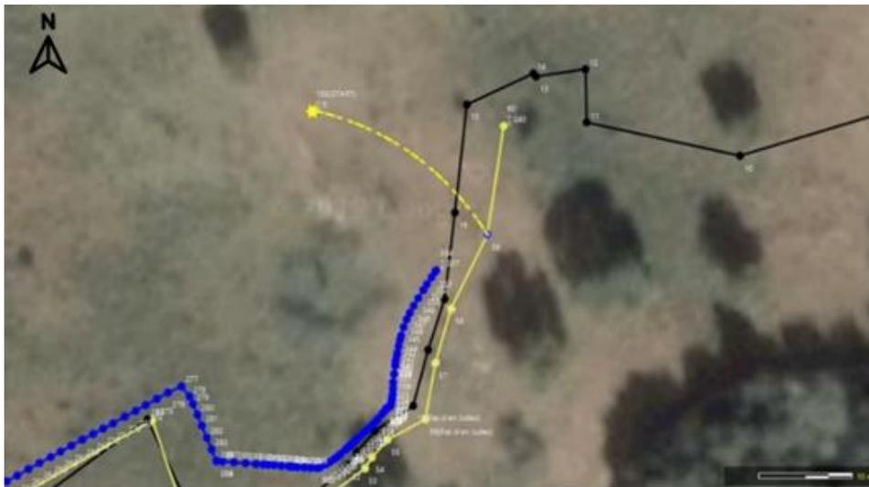
**Figura 73.** Imagen del software ARIANE donde aparece el punto topográfico (estrella amarilla) a 22,26 m del punto 59 del MNEMO. Fuente; elaboración propia.
