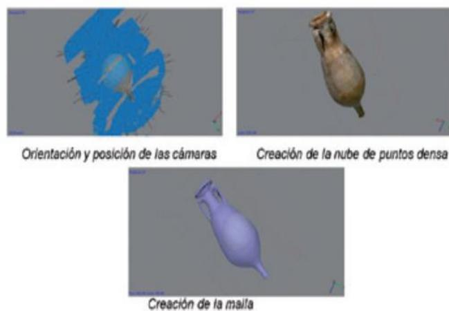
**Figura 22.** Ejemplo de las distintas fases del procesado fotogramétrico de un ánfora con el software Agisoft Metashape Professional. Fuente; (Moya y Muñoz, 2017).
