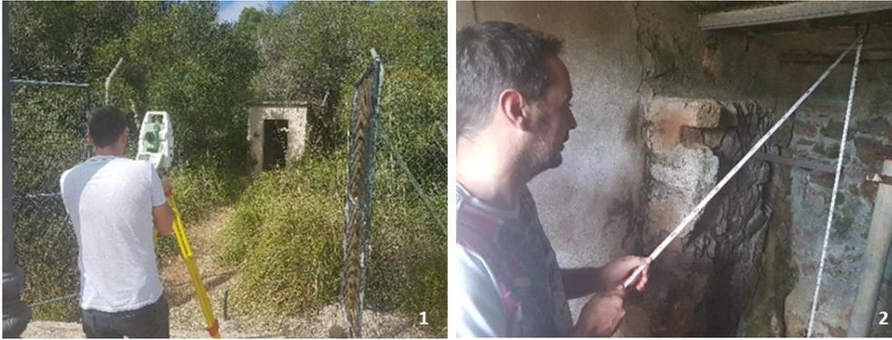
**Figura 120.** El topógrafo Pablo Cantuel tomando puntos con la estación total en el acceso a la cova de la Font de Ses Aiguades. **1.** Imagen de la estación total, la cual permitió realizar los cálculos de coordenadas de campo, replanteo de puntos y cálculo de acimut y distancias. (Foto; Autor). **2.** El topógrafo Pablo Cantuel midiendo la distancia con cinta métrica desde el gancho hasta el nivel freático del agua en la campaña arqueológica del año 2020. (Foto; Autor).
