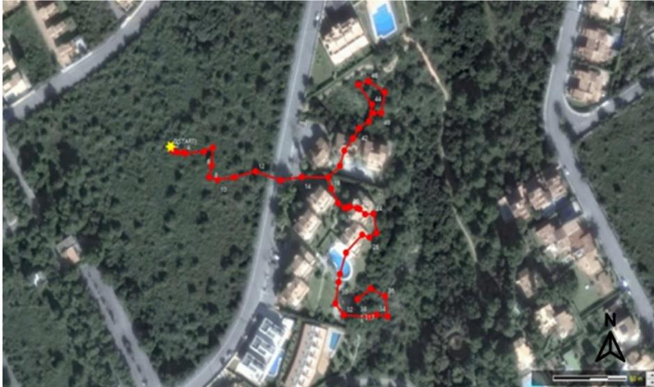
**Figura 101.** Imagen del software ARIANE donde aparece la línea de MNEMO correcta (línea roja), con el punto de inicio de lectura del hilo sumergido (estrella amarilla) calculado topográficamente con tolerancia topográfica centimétrica. Fuente; elaboración propia.
