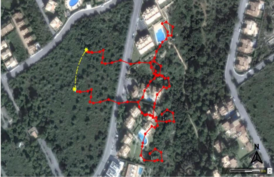
**Figura 100.** El error en la coordenada de inicio nos desplazó todo el modelo topográfico obtenido en las lecturas del MNEMO (línea roja) casi 60 metros al sur (línea amarilla) lo que nos permitió entender la importancia de una geo posición correcta del punto de partida de la lectura. Fuente; elaboración propia.
