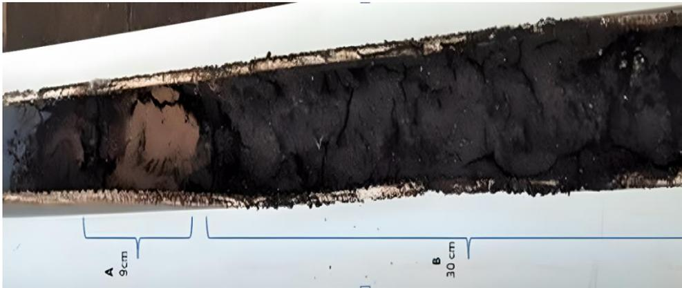
**Figura 68.** Imagen en detalle de la diferente estratigrafía obtenida por el core extraído en el punto 4 (Foto; Autor).
