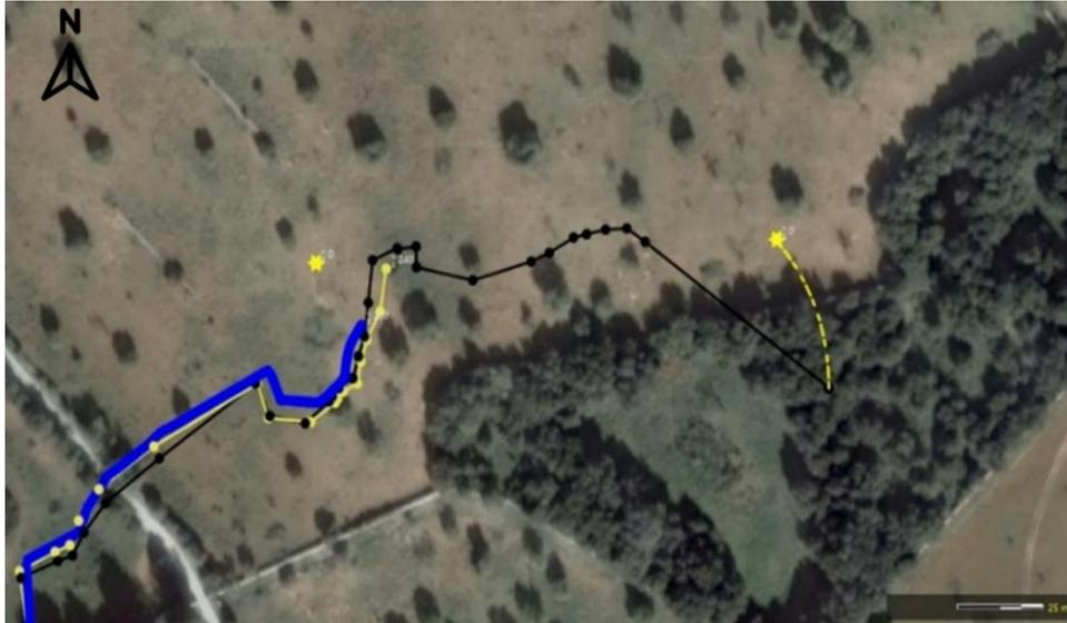
**Figura 74.** Imagen del software ARIANE donde aparece el punto topográfico (estrella amarilla) a 41.12 m del punto final del MNEMO (línea negra) en la Galería de las Cónicas. Fuente; elaboración propia.
