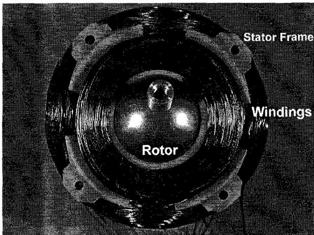
Fig. 1 Spherical actuator
