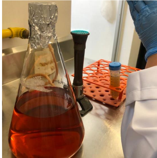
Figura 3. Inoculación de L. fermentum en matraz Erlenmeyer con 1.5 L de caldo MRS+Nutraflora 10%.
