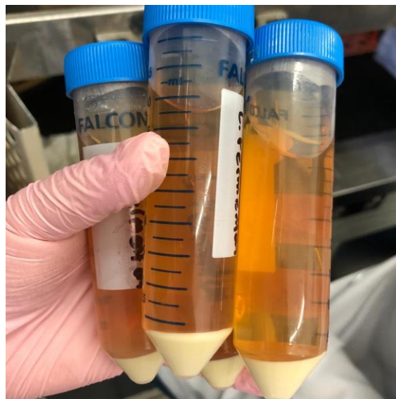
Figura 4. Tubos Falcon® con la biomasa recuperada después de su centrifugación. El sedimento en la parte inferior de los tubos corresponde a la biomasa.
