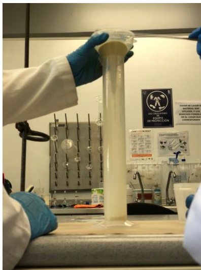
Figura 12. Prueba de densidad aparente de L. fermentum .
