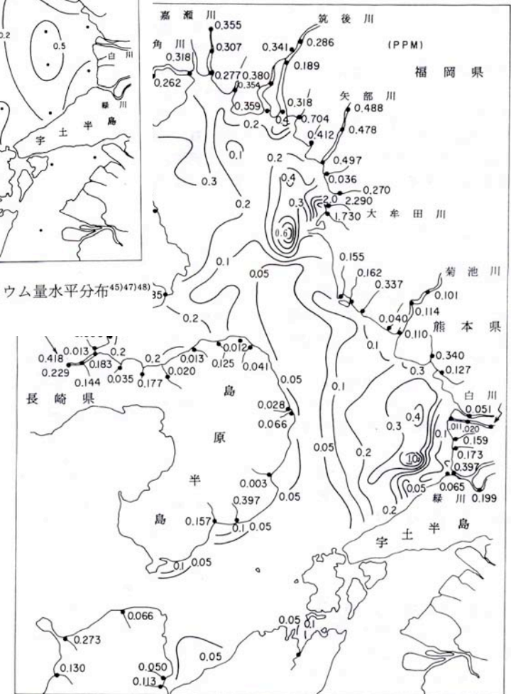
第17図 有明海の表層底土中の総水銀量の等濃度分布図 (環境庁, 1974 45) 調査年月……昭和48年8月) ●：河川の調査地点, 数字：総水銀量(乾泥当たり ppm)
