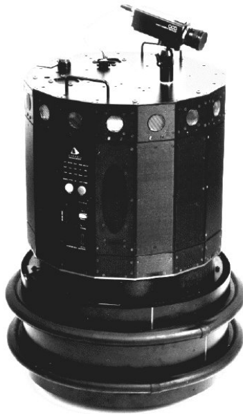
Fig. 4.8. The Nomad 200 mobile robot FortyTwo
