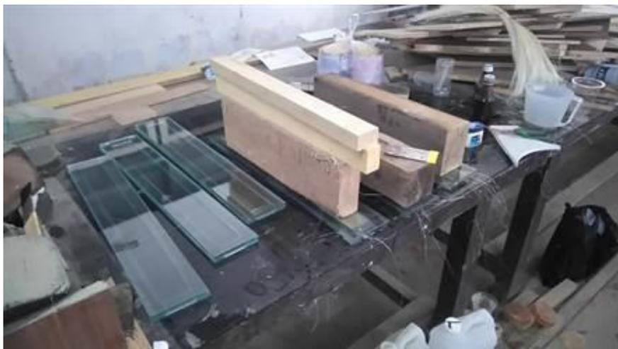
**Gambar 3. Pembuatan *Skin* komposit *polyester* dengan system *pressmoulding*.**
