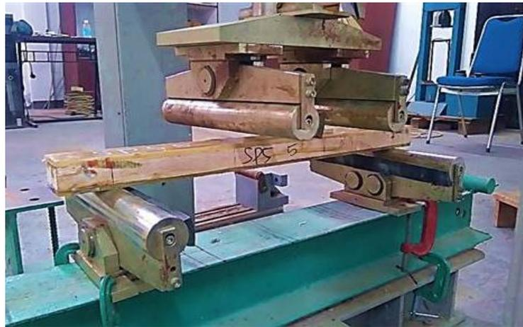
Gambar 7. Pengujian kuat lentur *Sandwich* Panel SPS
