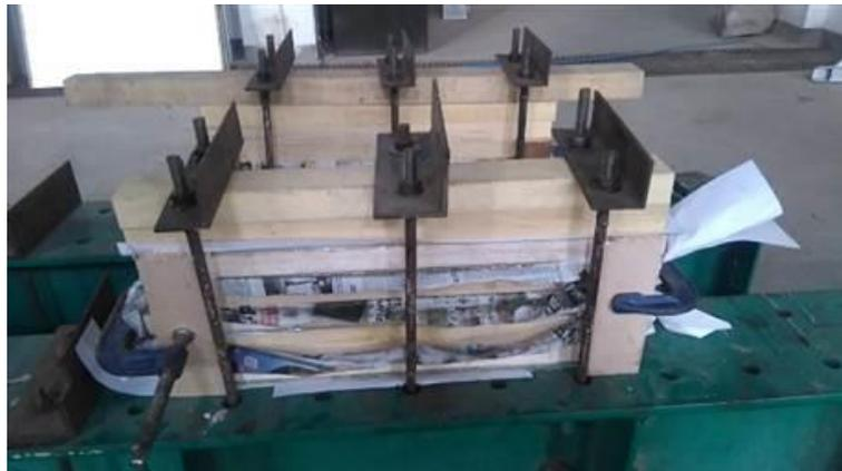
**Gambar 5. Proses pembuatan panel SPS**
