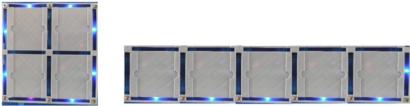
Fig. 3. Diseño físico de los contenedores de componentes electrónicos de las placas lectoras RFID.
