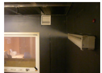
Air diffusion visualisation using fumes
