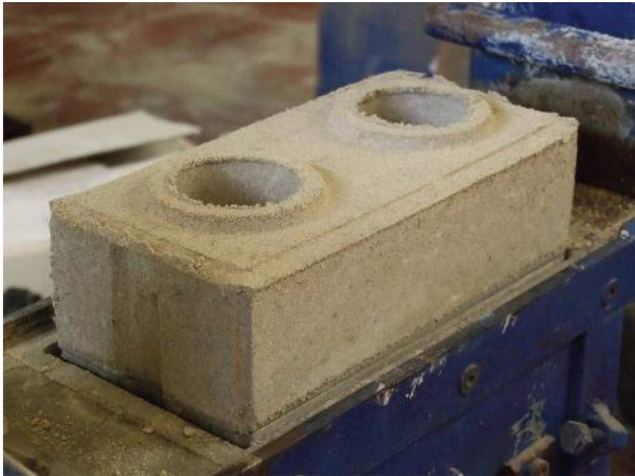
*Figura 2.22: BTC em prensa mecânica (foto Universidade do Minho)*
