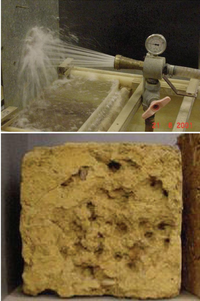
*Figura 5.4: Ensaio scelerado de erosão Bulletin 5: a) Equipamento; b) Provede erodido (Heathcote& Moore, 2003)*
