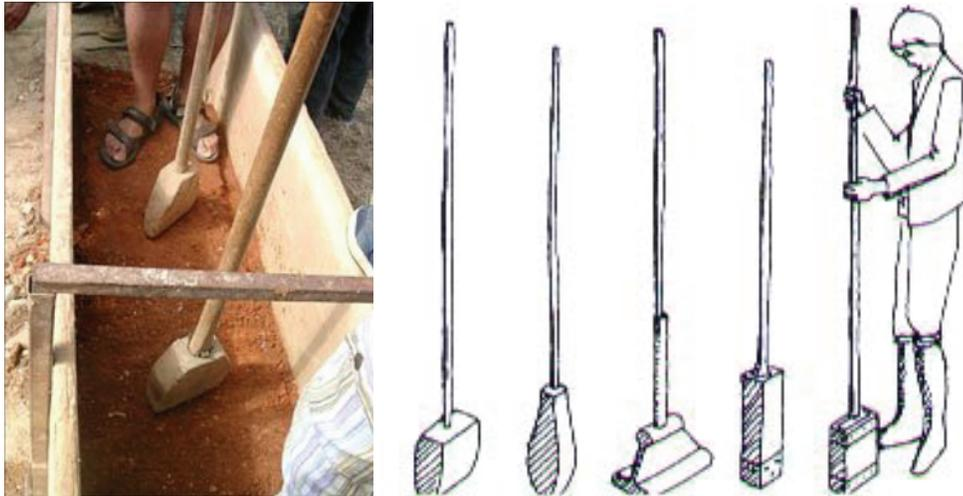
*Figura 2.7: Pilões ou maços utilizados na taipa tradicional*
