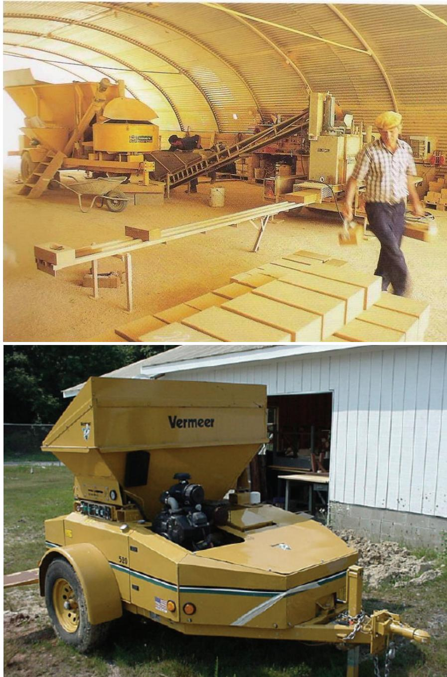
*Figura 2.23: Prensa hidráulica para fabrico de BTC: a) Fixa (Quintino, 2005); b) Móvel*
