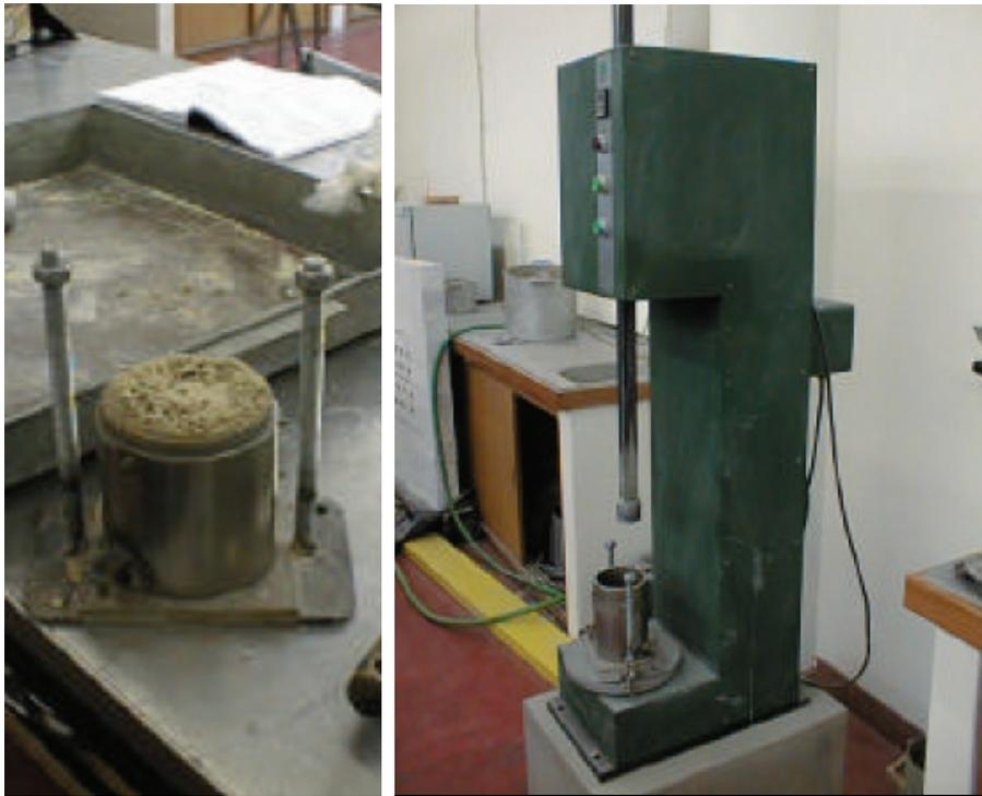
*Figura 3.1: Ensaio de compactação Proctor pesado: a) molde com solo; b) equipamento de compactação*
