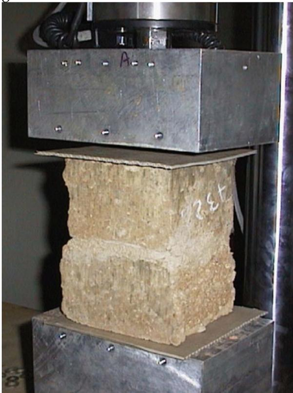
*Figura 4.3: Resistência à compressão- Procedimento do RILEM (Morel et al., 2007)*
