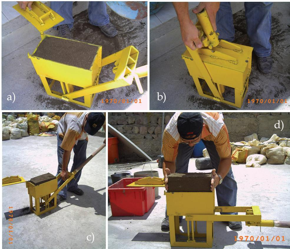
*Figura 2.21: Execução de BTC com a prensa Cinva-ram: a) Enchimento da câmara com terra; b) confinamento da mistura; c) elevação do BTC; d) retirada do BTC*
