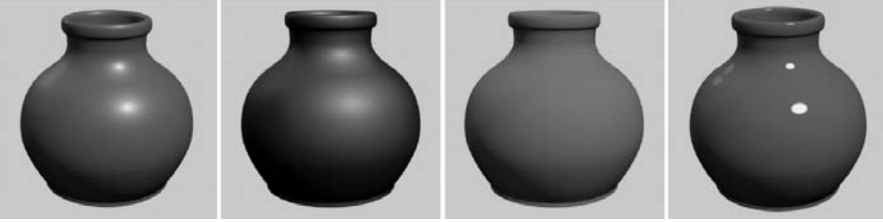
Fig. 151: Efeitos dos shaders , à esquerda temos reflexos mixed, e que dão origem a um efeito plástico; ao centro esquerda o efeito specular que confere uma vertente mais metálica; ao centro direita o efeito diffuse que atribui um carácter mate ao vaso; e à direita o efeito glossy que confere um cariz de vidro (Gritz, 2000)
