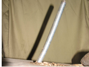
(d) Bending of the internal bolt
