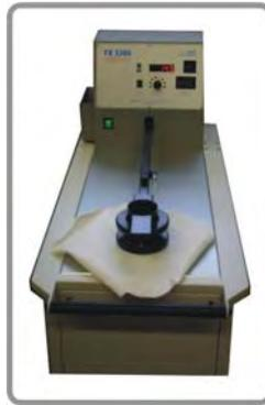
Aparelho – FX 3300 Air permeability tester III – Permeabilímetro ao ar
