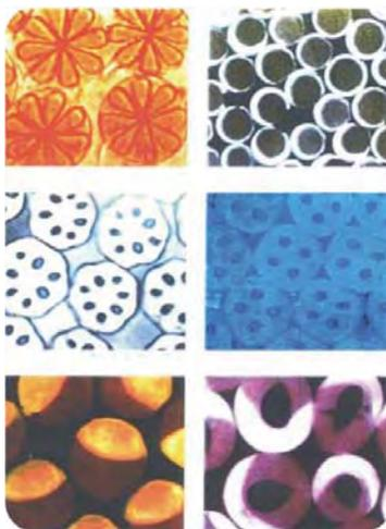
**Fig. 2.6 – Secção transversal de fibras bicomponentes**
