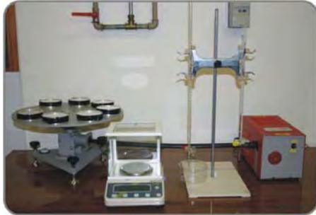
Aparelho – Permeabilímetro ao vapor
