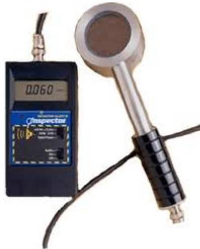
Figura 4.2. Detector de contaminación (cuentas/min): el detector es de (BF_3) , detecta gammas, betas, neutrones.
