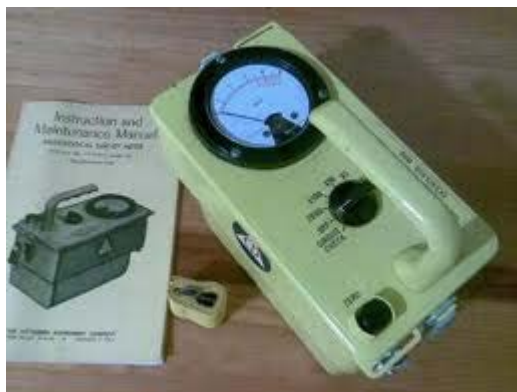
Figura 4.1. Detectores de exposición (mR/h): Rx, gamma y betas con altas energías. Solo realiza una medición cualitativa.
