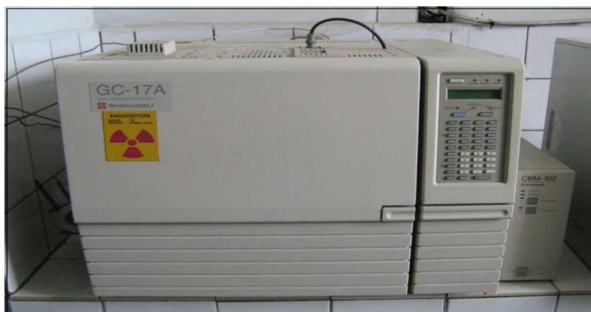
**Figure IV. 13.** Le chromatographe GC-17A utilisé pour l'analyse des échantillons.
