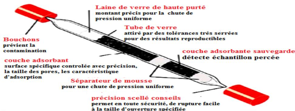
Figure IV.11. Exemple de support d'adsorbant
