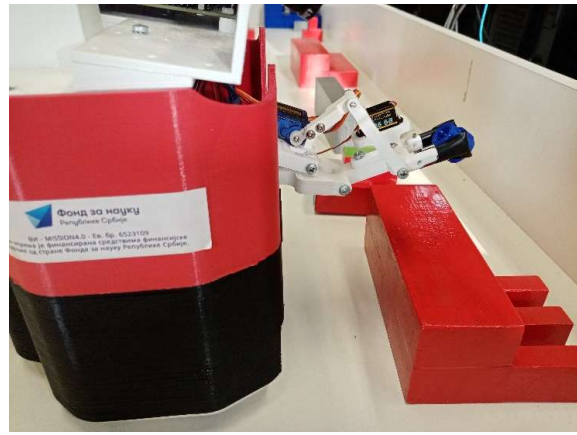
Slika 9. Mobilni robot RAICO tokom manipulacije mašinskog dela sa modela mašine alatke [34]
