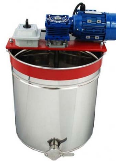
Рисунок 2 – Зовнішній вигляд пристрою для виготовлення крем-меду
